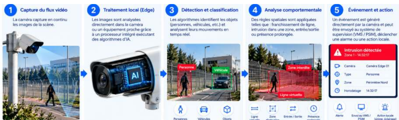
Schéma 1 : Détection vidéo Edge – de la capture du flux à l'événement et l'action
