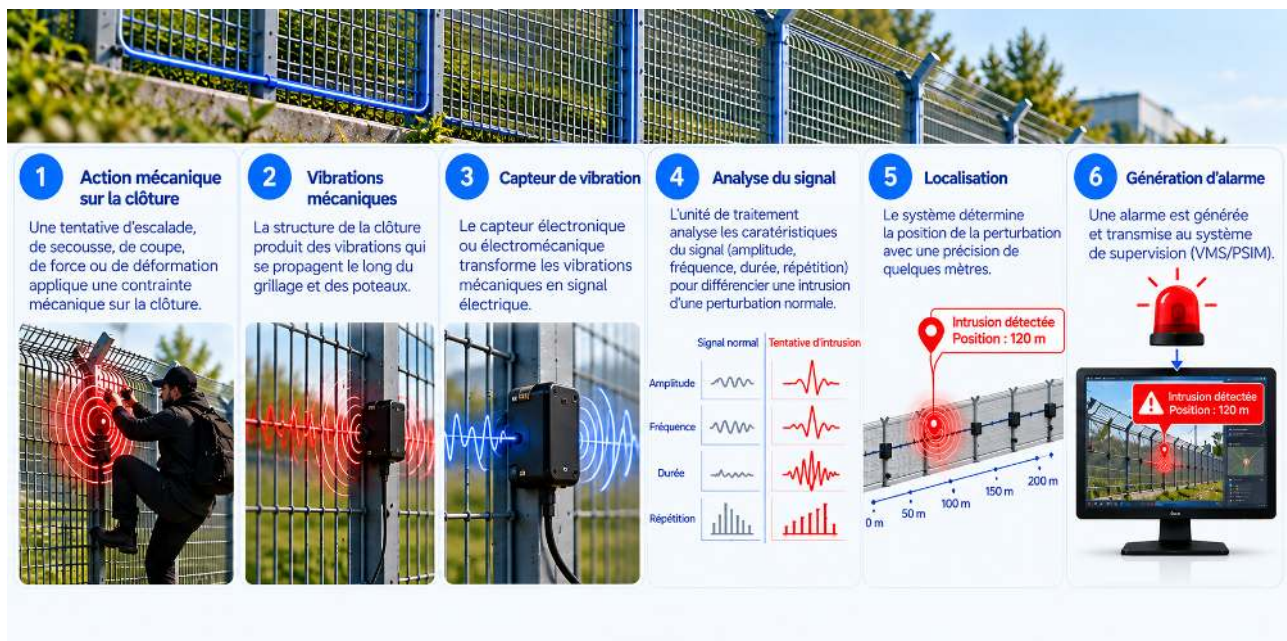
Schéma 2 : De l'action mécanique sur la clôture à la génération d'alarme
