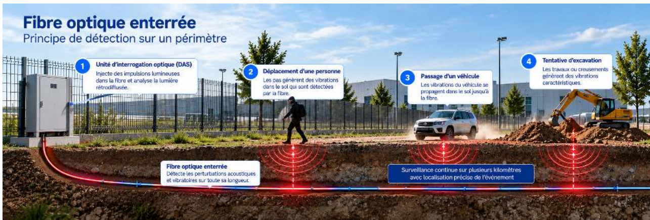
Schéma 3 : Fibre optique enterrée – principe de détection sur un périmètre
