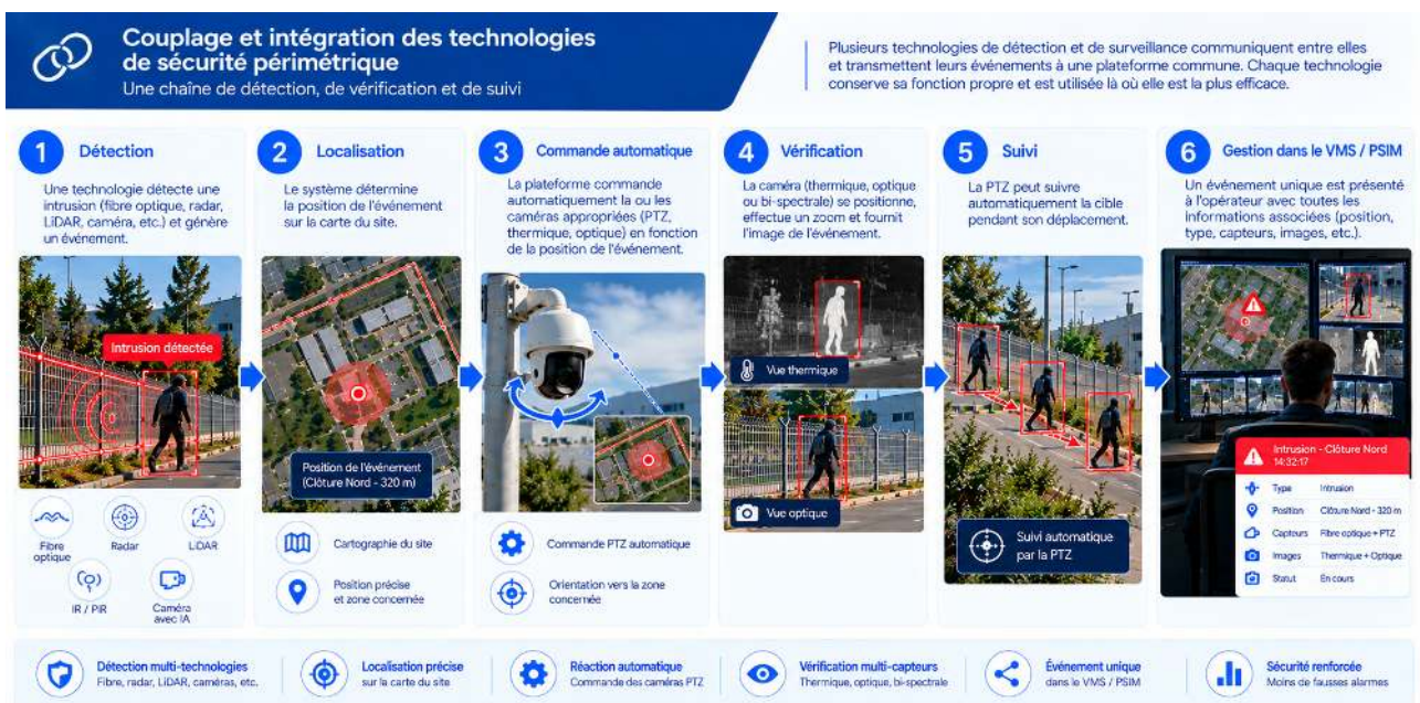
Schéma 2 : Chaîne de fonctionnement mixte – de la détection à la gestion dans le VMS / PSIM
