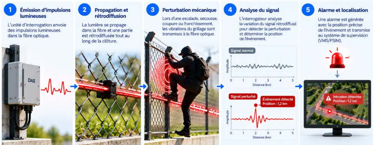
Schéma 2 : Principe de détection – de l'émission lumineuse à l'alarme avec localisation
