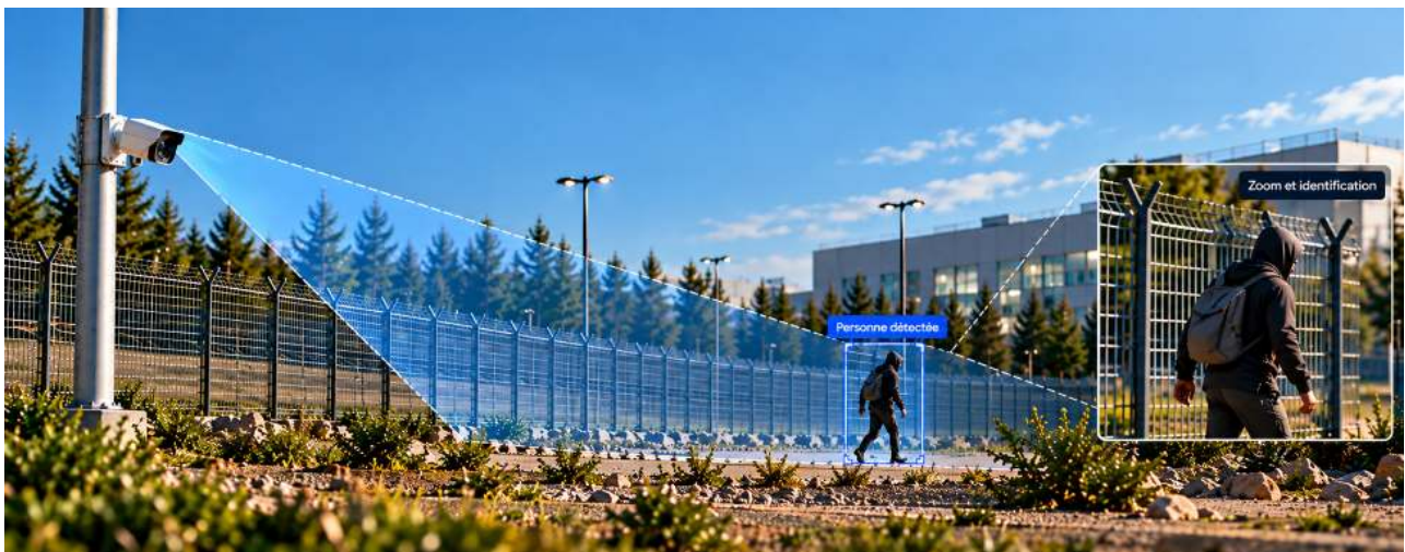
Schéma 1 : Caméra optique – détection, zoom et identification visuelle
