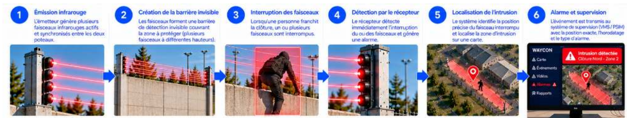
Schéma 3 : Chaîne de détection – de l'émission infrarouge à l'alarme et la supervision
