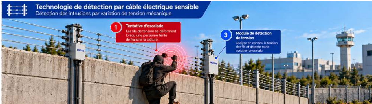
Schéma 1 : Câble électrique sensible – détection des intrusions par variation de tension mécanique
