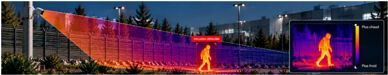
Schéma 1 : Caméra thermique – détection d'intrusion par signature thermique
