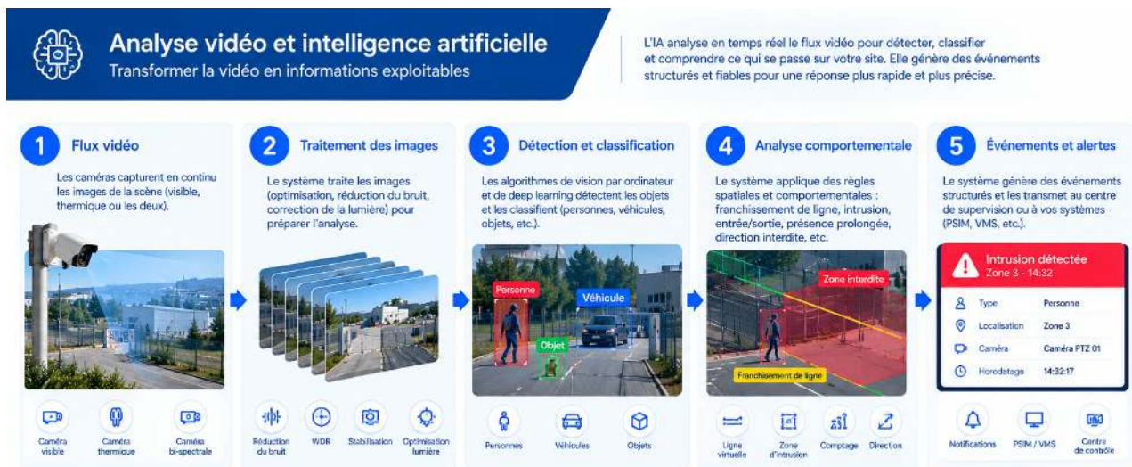
Schéma 1 : Analyse vidéo et IA – du flux vidéo aux événements et alertes
