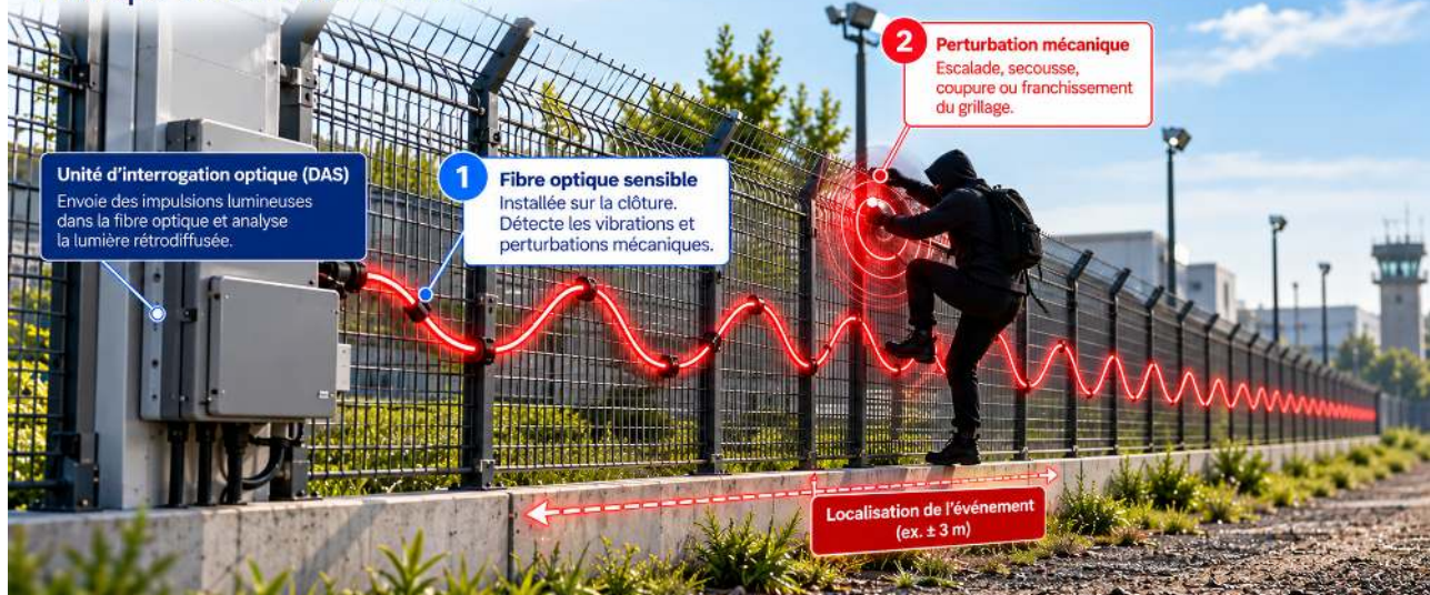
Schéma 1 : Fibre optique sur clôture – principe et fonctionnement
