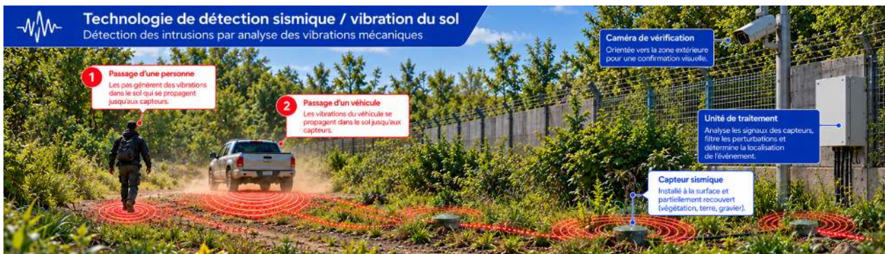
Schéma 1 : Détection sismique / vibration du sol – détection des intrusions par analyse des vibrations mécaniques
