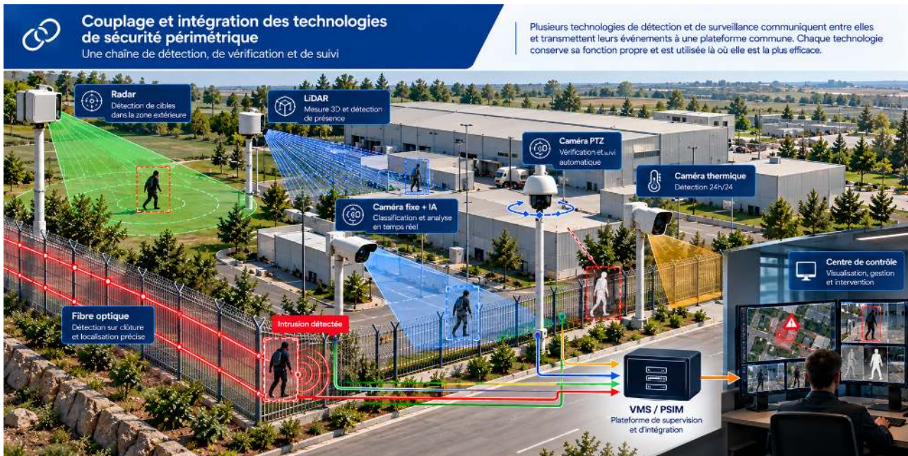
Schéma 1 : Couplage des technologies – vue d'ensemble du site et remontée vers le VMS / PSIM
