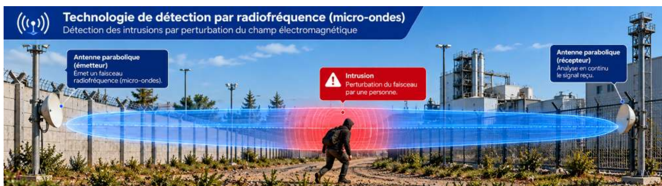
Schéma 1 : Détection par radiofréquence (micro-ondes) – perturbation du champ électromagnétique entre antenne émettrice et antenne réceptrice
