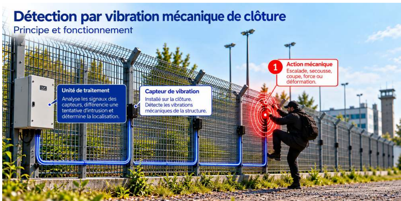
Schéma 1 : Détection par vibration mécanique de clôture – principe et fonctionnement
