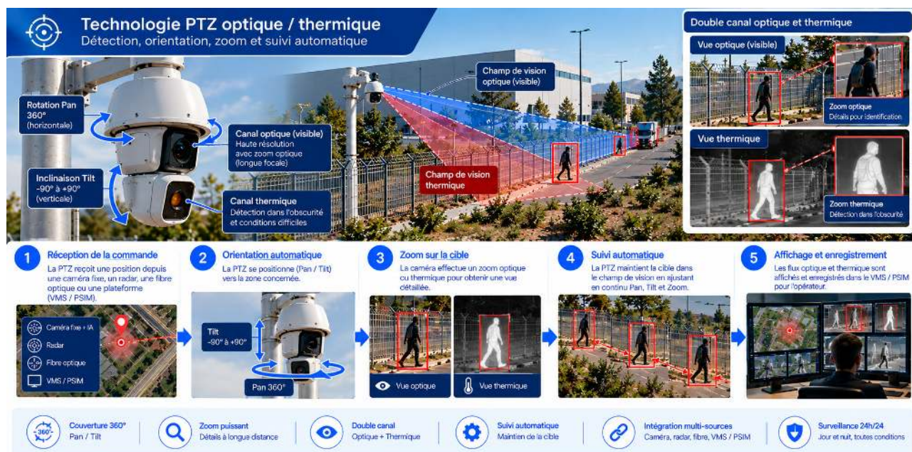
Schéma 1 : Technologie PTZ optique / thermique – détection, orientation, zoom et suivi automatique
